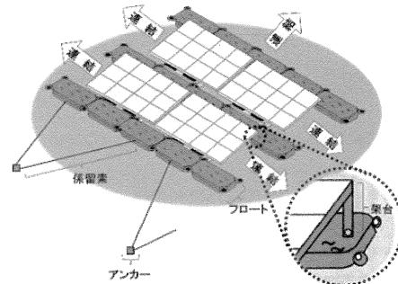
解説 46.1 図 水面等に施設される太陽電池発電設備の支持物
